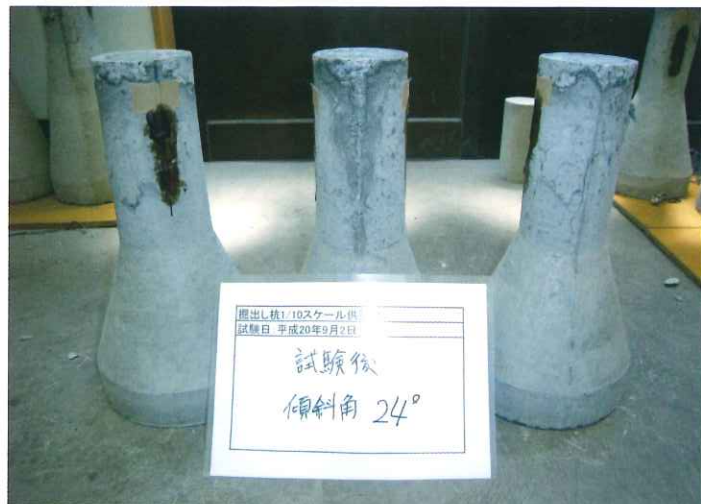
1/10モデル破壊実験供試体状況(傾斜角24°)
